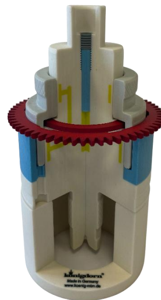
Abbildung 1: Spanndorn zum Messen der Außenverzahnung
